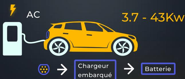
En courant alternatif (AC), le courant électrique venant du réseau électrique, à travers la borne, est converti à l'aide du chargeur embarqué dans le véhicule.
